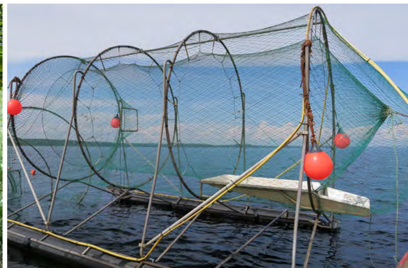
Selektiv push-up-fälla för laxfiske. Under 2022 ändrades reglerna för fiske av lax i Ljungans fredningsområde. Fällan ska vara utformad på ett sätt som medför att små fiskar eller fel arter kan släppas tillbaka i vattnet på ett skonsamt sätt.
